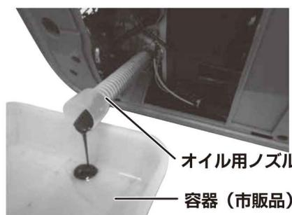
④廃油を受け取る容器（市販品）の上で本体を傾け、エンジンオイルを抜きます。
