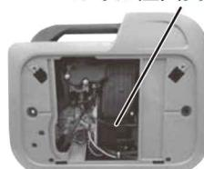
②オイル注入口キャップを外し、付属のオイル用ノズルを取り付けます。
