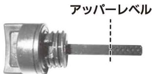
④オイル注入口キャップを締め、メンテナンスカバーを取り付けてください。
