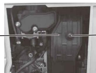
②フィルターカバーを留めているネジを取り外し、フィルターカバーを取り外してスポンジフィルターを取り出します。
