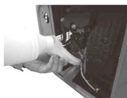
③オイル注入口キャップのゲージで規定量給油されたか確認してください。
